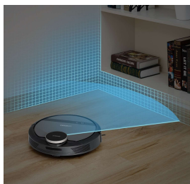
レーザーによる非接触で 360 度お部屋の形状を把握
