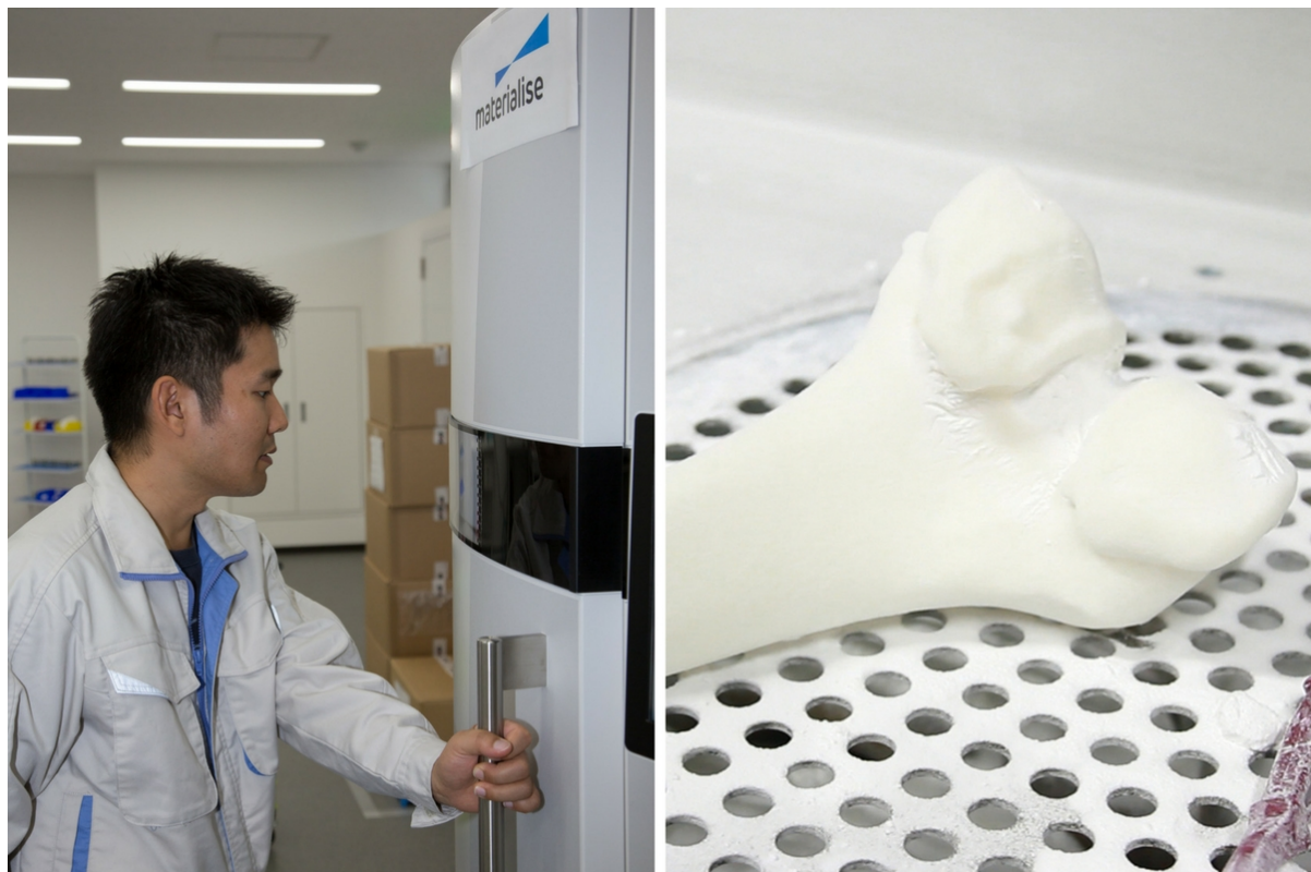
川崎市内の国内製造拠点の造形機と 3D プリントで製造される骨モデルの例
