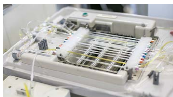
「アミロース」含有量の測定に使われるオートアナライザー。
