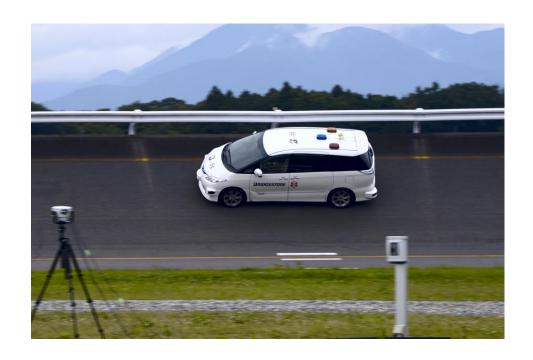
当社は、現在プルービンググラウンドにおいて、テストドライバーが運転する車両を用いた様々なタイヤ性能試験を行っています。この度、ZMP 社とタイヤ性能試験の一つであるタイヤ騒音試験を SAE レベル 4 の無人自動運転化するための開発プロジェクトを開始しました。
