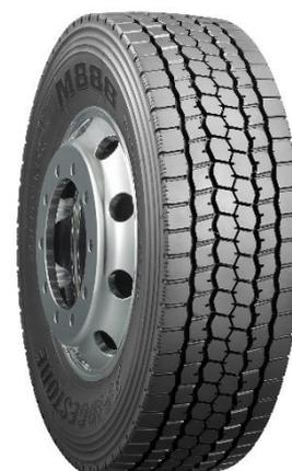
今回発売する「M888」は、タイヤの接地面のブロック変形を抑制し、接地圧を均一にする新たなトレッドパターン「アドバンスドコンタクトパターン※1」を採用することで、「M890」対比摩耗ライフ性能を20%向上※2させています。さらには、ブロック剛性およびブロックの大きさを最適化することでエッジ効果を向上させるとともに、ウェット性能を確保しています。また、空気の透過性をブロックするインナーライナー※3によって優れたケース耐久性を確保しているため、一部のサイズ※4で2回リトレッド※5を実現します。
