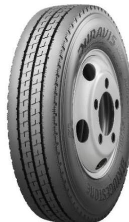
新商品「DURAVIS R207」は、長年好評だった従来品「DURAVIS R205」の性能を維持するとともに、ウェット路面での発進時のグリップ性能に配慮し安全性を確保しています。また、運送事業者様の稼働をサポートするため、従来品「DURAVIS R205」対比耐偏摩耗性やウェット性能を同等に保ちながら、摩耗ライフを 25%<sup>\*1</sup> 向上しています。
