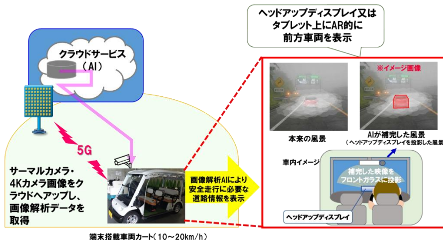
図10 5Gを活用した濃霧の中での運転補助に関する実証試験
