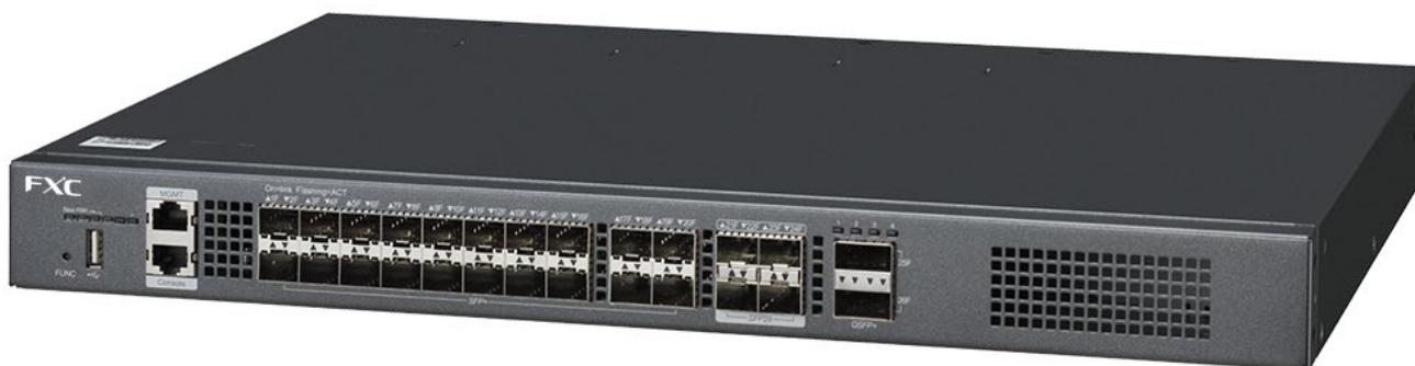
「FXCX9526F」は、20 ポートの 1G/10G SFP+と、4 ポートの 10G/25G SFP28 と、2 ポートの 40G QSFP+を搭載可能な管理機能付 L3 スイッチです。
