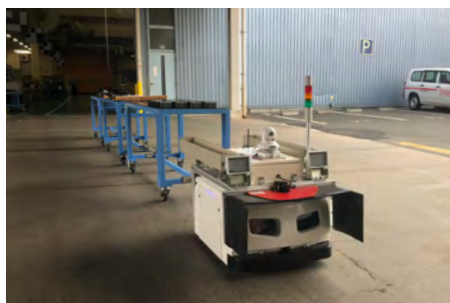
工場 建屋間搬送
