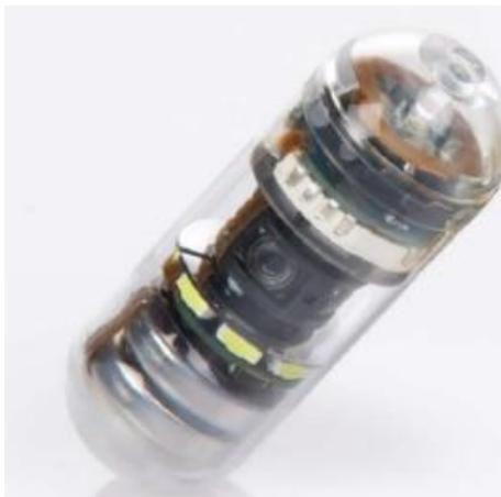
胃や大腸、小腸などを検査する内視鏡はチューブ型の内視鏡が一般的ですが、患者様の症状によって、心理的・身体的負担がより少ない、口から飲み込むカプセル型の開発・利用が広がっています。CapsoCam Plus は直径 1.1 cm、長さ約 3 cm で、業界初となる 360° の高画像パノラマ撮影を可能とする 4 台の小型カメラ、照明用 LED、データを記録するフラッシュメモリー、バッテリー等を搭載。小腸内で最大約 15 時間の撮影が可能です（1 秒間に 2～5 フレーム）。2010 年から製造が開始され、現在は欧米を中心に約 50 ヶ国・地域で販売されています。
