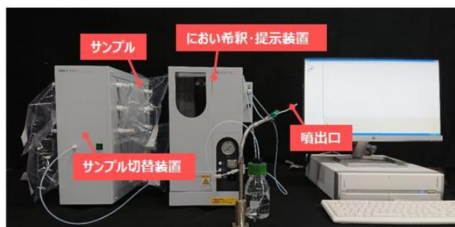
図1 におい強度の計測装置
