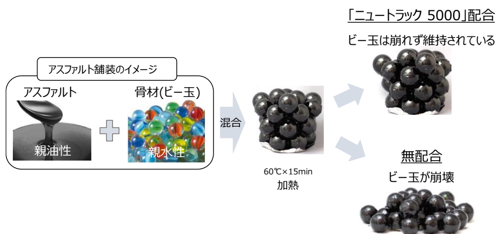
図1. アスファルト舗装における「ニュートラック 5000」の作用イメージ
