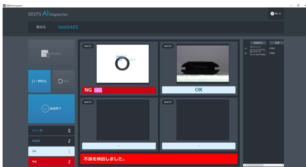
【写真 1：品質検査 AI パッケージの画面キャプチャ、上面および側面の 2 方向から検査】
