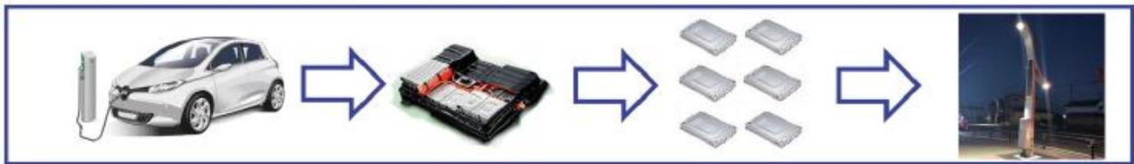
使用済みEV自動車用のリチウムイオンバッテリーを独立電源街路灯へリユース(イメージ)
