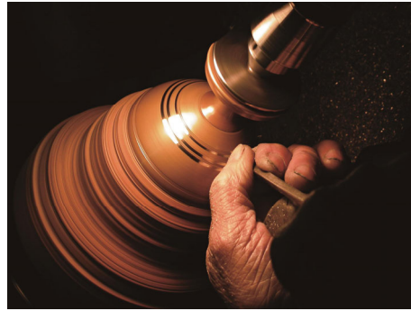
模造 黄銅合子の表面を削っている様子
