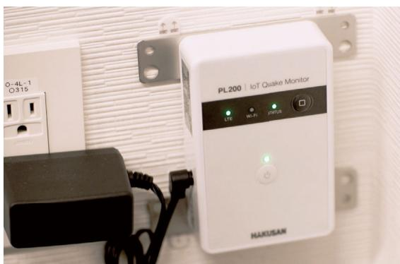
各物流センターに設置した地震計で、地震時の揺れを計測。
