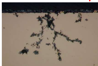
図1-1：「アリの巣状腐食」のエアコンの冷媒配管の断面の拡大図（左図）、アリの巣のイメージイラスト（右図）
