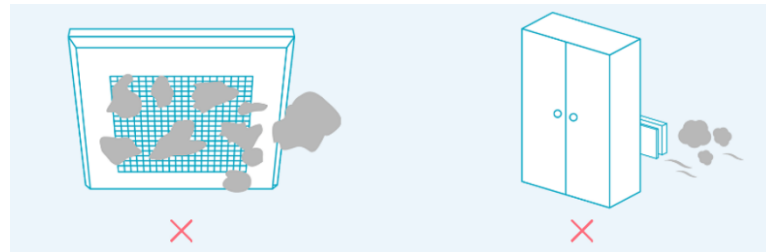
換気扇に汚れが詰まっていますか？
