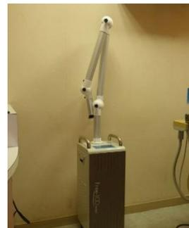
切削時の飛沫を吸引し、口腔内のだ液や血液を含んだ飛沫が室内に浮遊するのを防ぎます。診療室内の空気汚染防止に有効。
