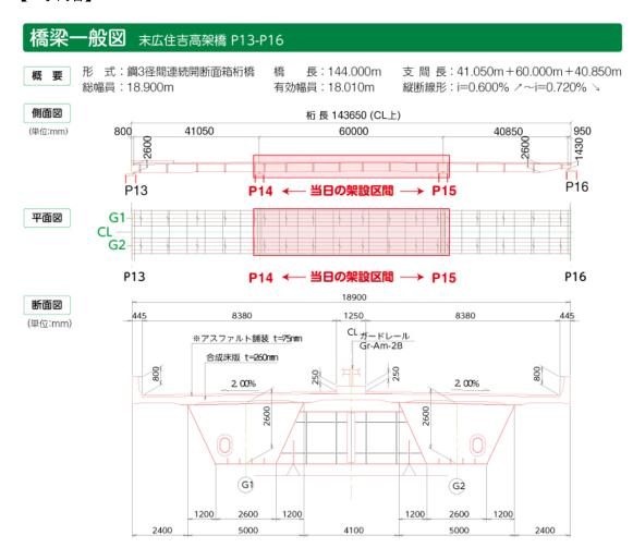
今回の工事では、交差点背面のヤードに軌条設備を組み立て、軌条設備上で架設と前進を繰り返し所定の高さまで橋桁を組み上げた後、橋桁の先端に多軸式自走台車を設置。多軸式自走台車の推進力で橋桁を繰り出し交差点の径間を架設します。この工法により交通規制期間を1夜間に抑えることができます。
