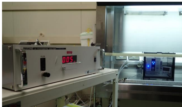
本研究における試験の様子。左：デシケーター内でのオゾン曝露の様子。右：オゾン濃度モニターによるオゾン濃度の制御。
