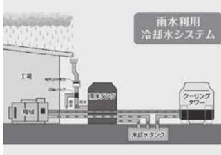
製品名 雨水利用工場冷却システムと工場配管
