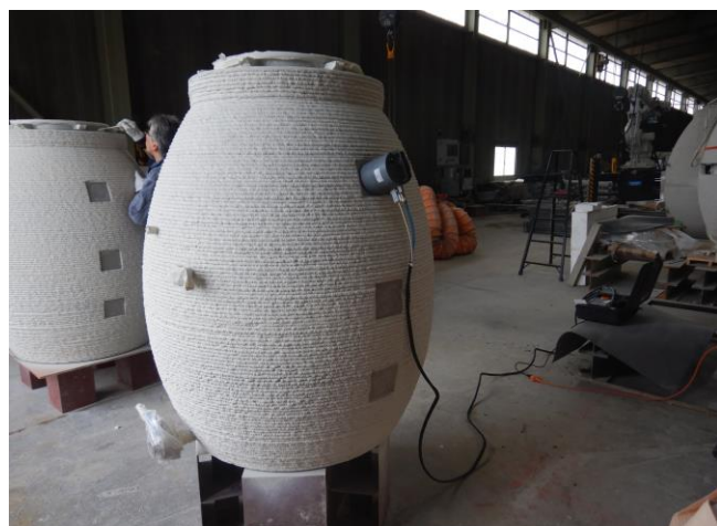
ステンレスタンクと比較するコンクリートタンク（エッグ型）
