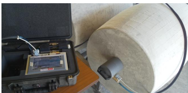
コンクリート酸素透過性のセンシング
