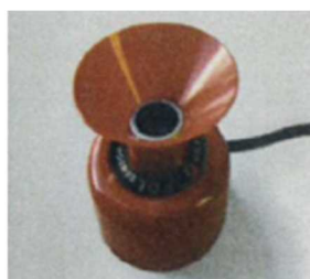
超音波センサー （部分放電の監視）
