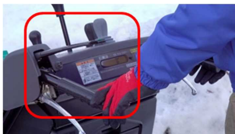
図 2: デッドマンクラッチ機構(安全機能)(提供:NITE)
