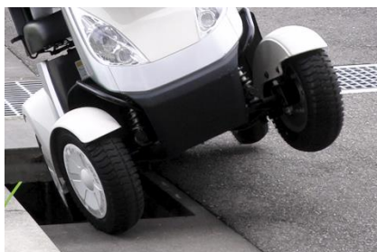
電動車いすが側溝で脱輪
