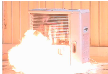
ガソリンの誤給油により石油ストーブから発火
