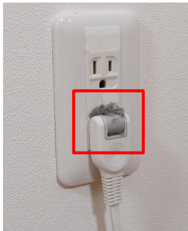
ほこり等の付着によりトラッキング現象 ※2 が生じてコンセントが発火
