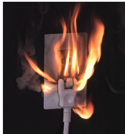
ほこり等の付着によりトラッキング現象 ※2 が生じてコンセントが発火
