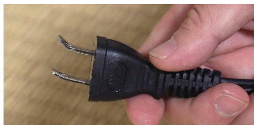
変形した電源プラグ
