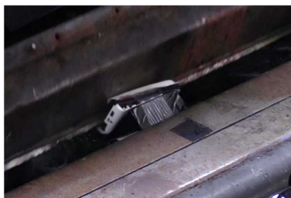
ごみ収集車にモバイルバッテリーが挟まれて発火
