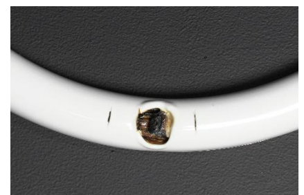
LED ランプの溶融（再現実験）
