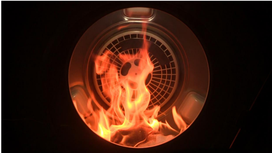
写真 アロマオイルが付着したタオルがドラム式洗濯機内で発火する様子
