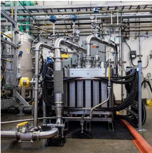
試験装置に設置されたメガワット級の PEM(プロトン交換膜)型水電解スタック 写真 シェフラー
