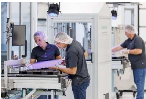
ドイツ・ヘルツォーゲンアウラッハの PEM 型水電解スタック組立ライン 写真 シェフラー (Daniel Karmann)
