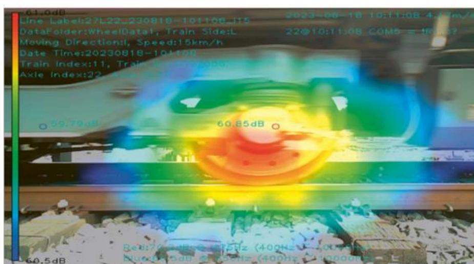
据え置き型の音響熱管理システム(ATMS)は、マイクロホンアレイを使用して、ノイズ放射に基づく損傷を可視化します。
