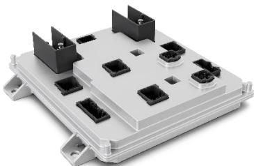
「Zone Controller」は、車両ゾーン内のすべての制御装置、センサー、アクチュエーターの接続・制御・電源に関する要件を一元化します。
