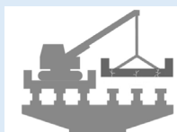
損傷した鉄筋コンクリート床版の取り外し
