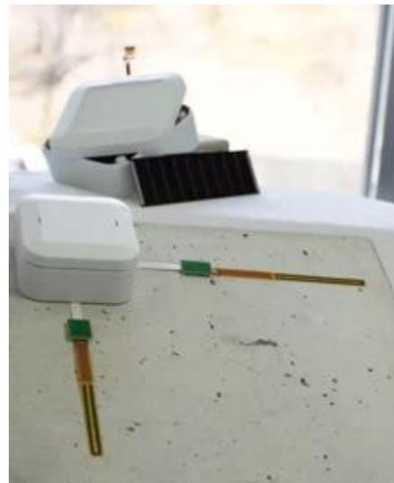
ひずみセンサ設置例
