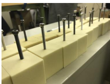
▲産業技術総合研究所（つくば）での試験の様子。様々な骨ねじで何度も試験を繰り返しました。
