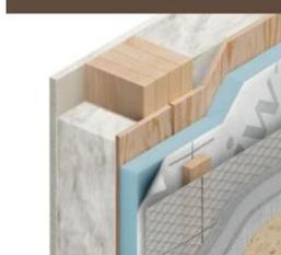
遮熱外張り断熱通気外壁（木造）
