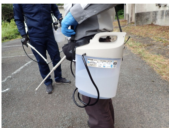
図 4：既存の肩掛け式液剤散布機を、粘度のある生分解性MFCハイドロジェルベイト剤を排出できるように改良したハイドロジェルベイト剤散布機。
