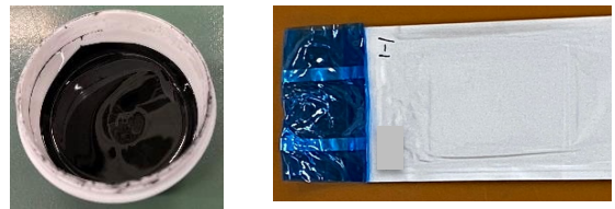
Figure 1. 作製した電極スラリーとラミネートセル写真
