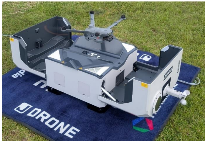
【自動充電ポート：DJI Dock 2、ドローン：Matrice 3TD】
