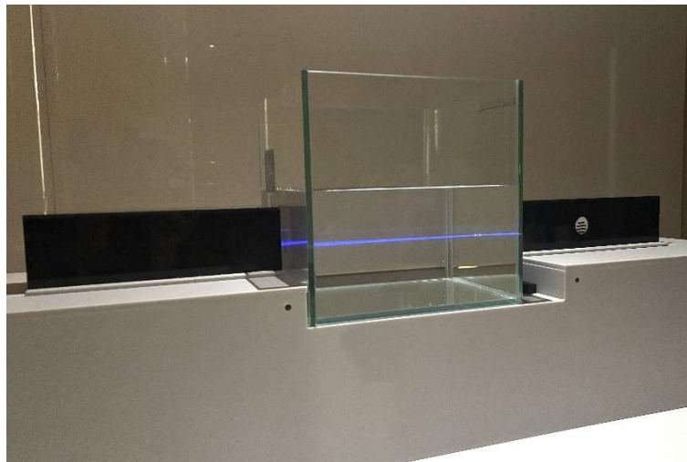
京セラの超高速水中光無線通信技術による水中光通信の様子
