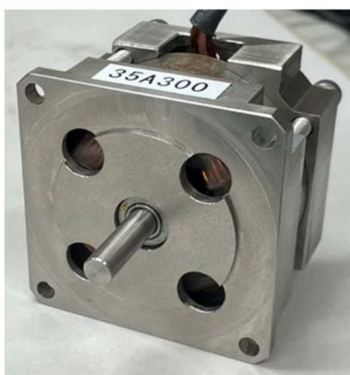
図 2. 強磁性窒化鉄ボンド磁石を用いたモータ
