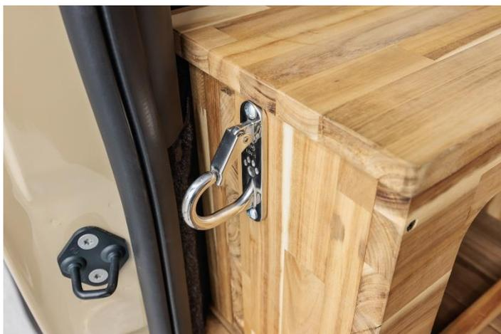
ドア開閉時ペット飛び出し防止のためリードフック設置
